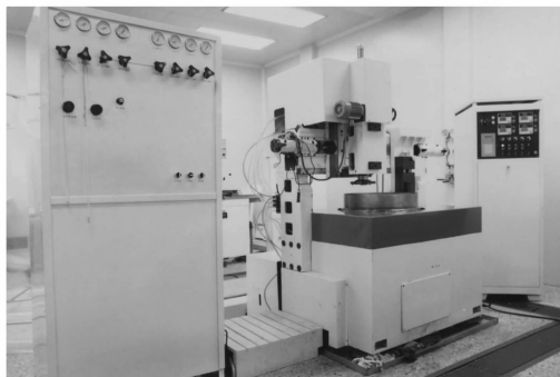
图 3 CJY-500 超精密研磨机
